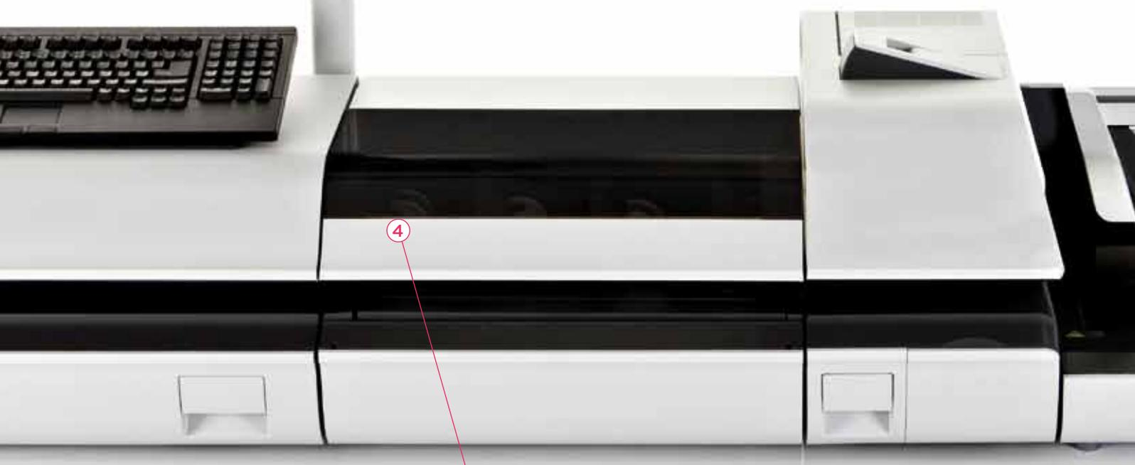
**4. Die dynamische Waage** ermittelt das korrekte Porto auf Basis von Format und Gewicht des Versandguts und errechnet die erforderliche Frankierung bis zu einer Frankiergeschwindigkeit von 140 Briefen pro Minute.
